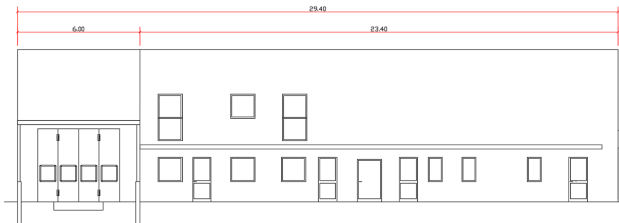
Figura 5 – Prospetto lato ovest del magazzino lavorazione uova
