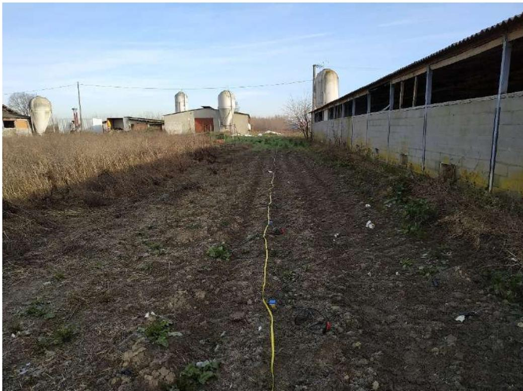
**Fig.10** – Stendimento sismico
