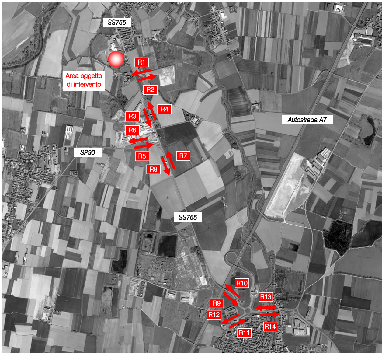
Figura B.1 – Sezioni di rilievo tramite strumentazione radar
